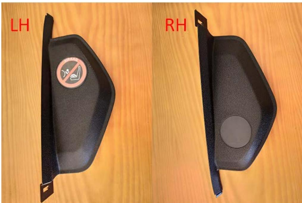
Figura 52. Marca Airbag LH-RH
