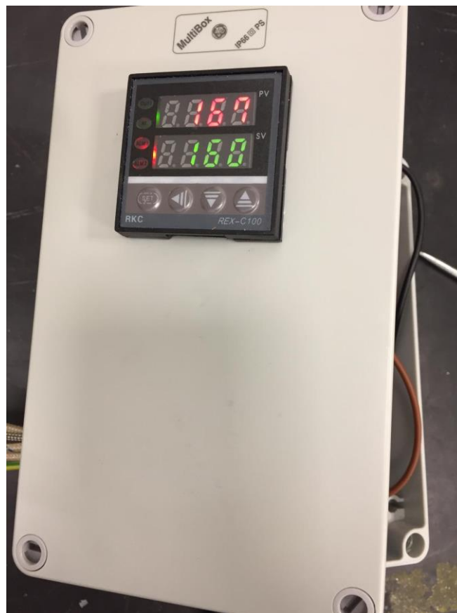
Ilustración 40: indicadores de la temperatura del calentador del molde.
