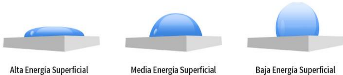
Ilustración 14: humectabilidad según la energía superficial del material. [4]
