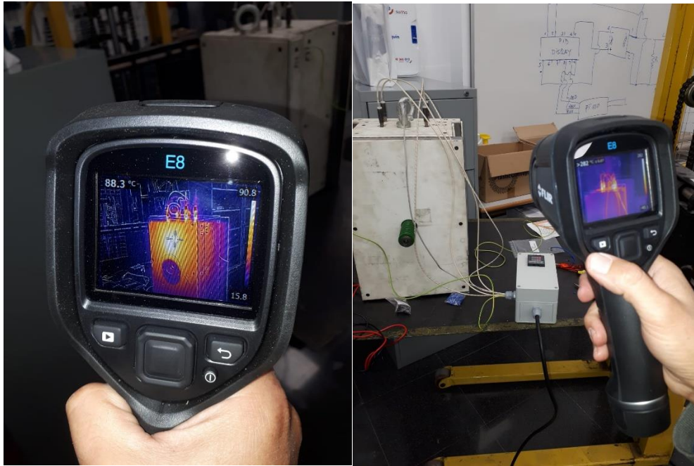
Ilustración 39: medición de la temperatura del molde en la inyección.
