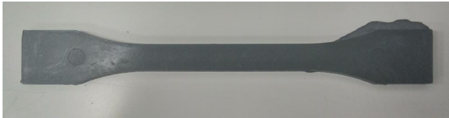
Ilustración 38: probeta de PPS con 20% de Fibra de Carbono.
