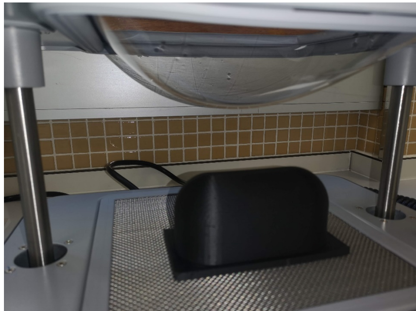
Fig. 58. Calentamiento óptimo de la lámina PETG
