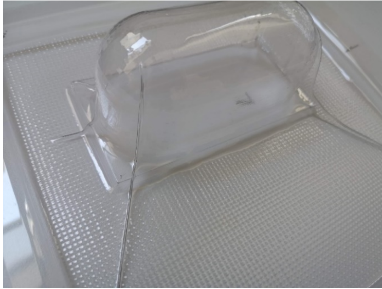
Fig. 64. Pieza termoconformada con errores detectados.
