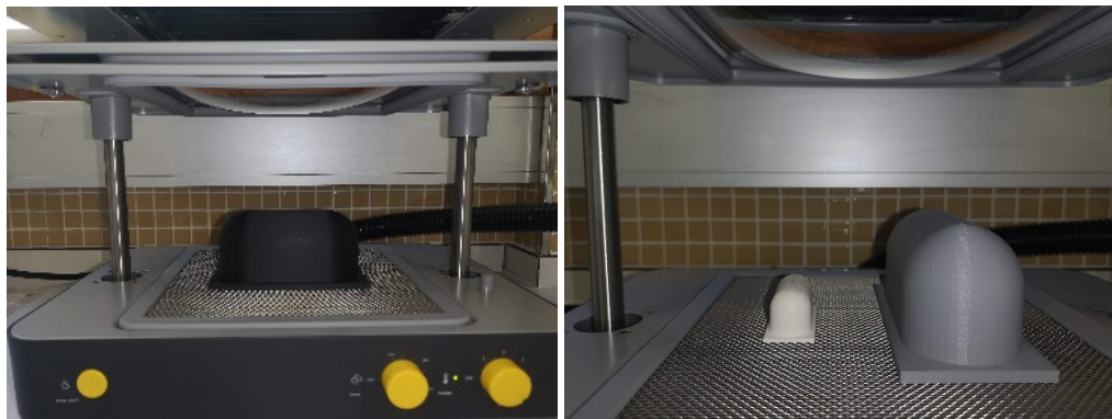
Fig. 57. Primeras ondulaciones de la lámina PETG tras el calentamiento.
