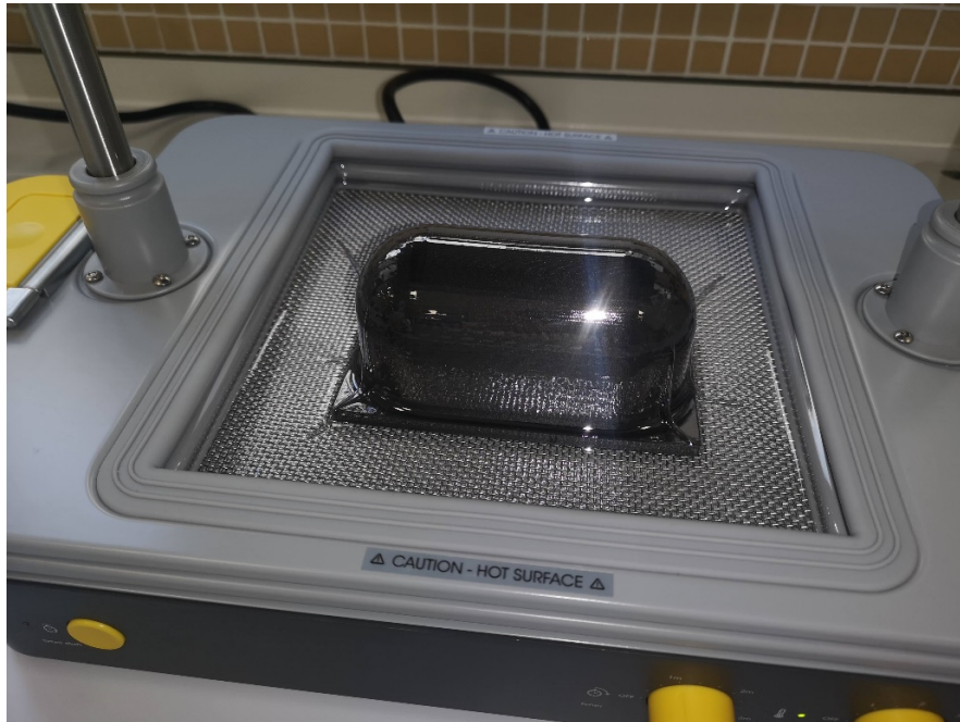
Fig. 59. Succión del aire para el correcto acople de la lámina PETG al molde.
