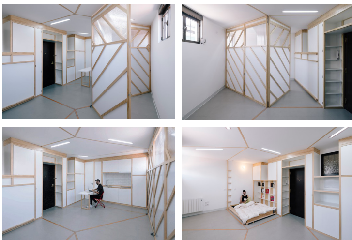
F 114. Secuencia de despliegue del Biombo en Biomboblastic que configura distintos ambientes para trabajar o descansar
