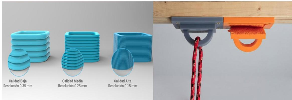
Ilustración 4. Resolución en Z y fallo a tracción por anisotropía
