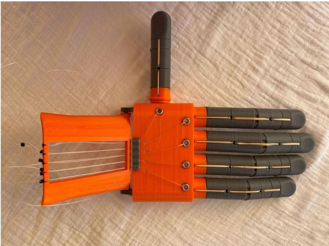
Ilustración 53. Prótesis mano montada: vista 1
