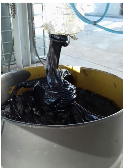
Figura 3.7. Descarga de plástico fundido a bidón por la parte inferior del fusor.
