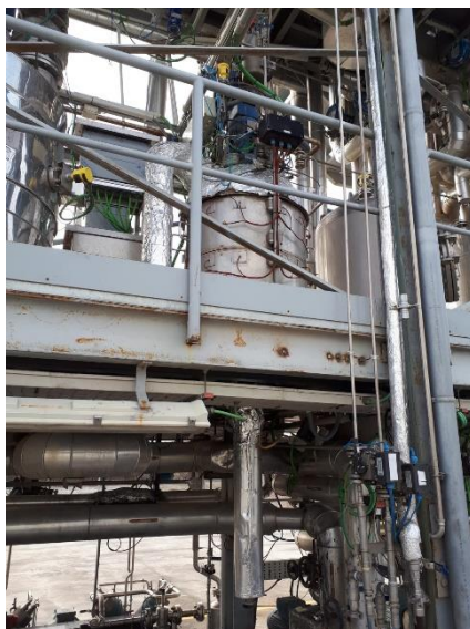
Figura 3.8. Reactor de craqueo térmico (R-201) de la planta piloto de valorización de plásticos.
