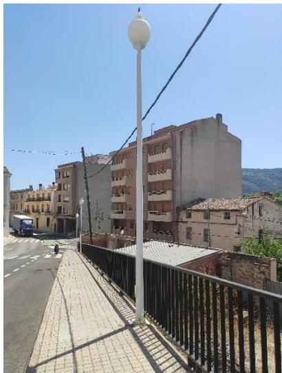
**Figura 20. Luminaria esférica sobre columna con bloque óptico opaco de 5 metros de altura**
