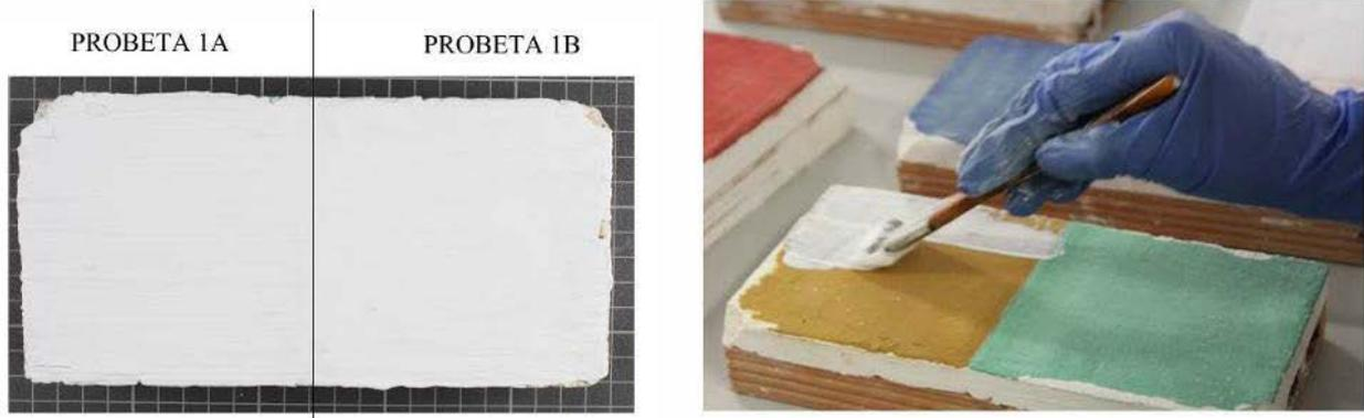
Fig. 2 Ejemplo de inducción de una de las alteraciones: encalado
