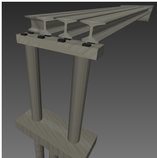
Imagen 23: Detalles de las vigas, neoprenos y pila (Istram)
