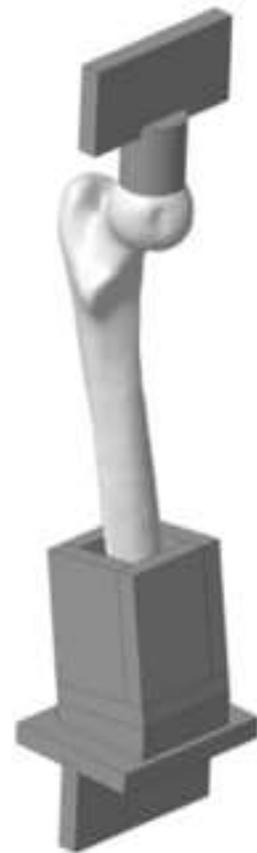
Figura 3. Especimen sobre banco de pruebas experimental con las [Click here to download high resolution image](#)
