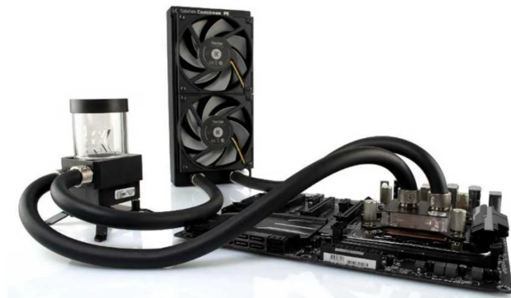
Figura 25: Sistema de refrigeración líquida con bomba y depósito (izquierda), radiador (centro) y bloque refrigerante sobre la CPU (derecha).
