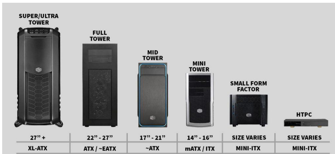
Figura 1: Factores de forma de los chasis de un computador.
