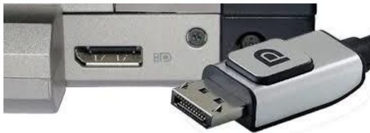
Figura 8: Puerto y conector DisplayPort.
