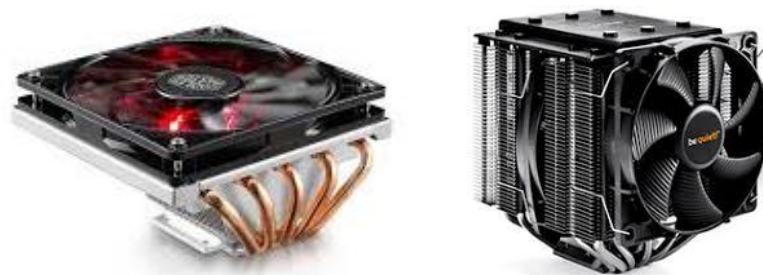
Figura 23: Disipadores de bajo perfil (izquierda) y de torre (derecha).
