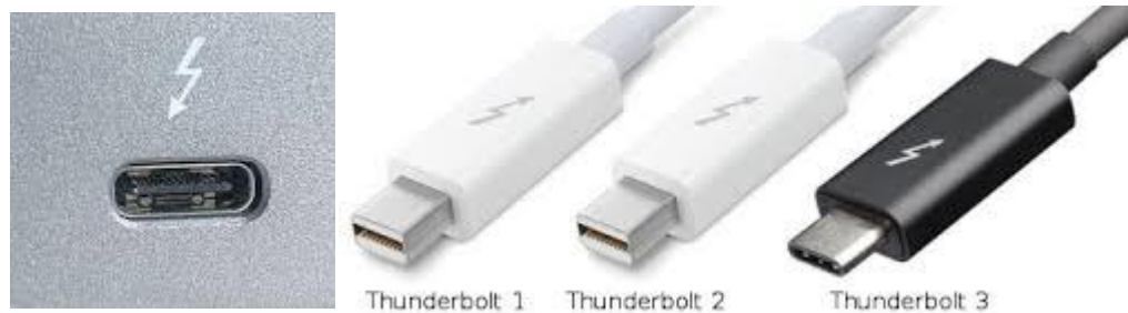
Figura 13: Puerto USB tipo C para Thunderbolt y conectores de las tres versiones de la interfaz.
