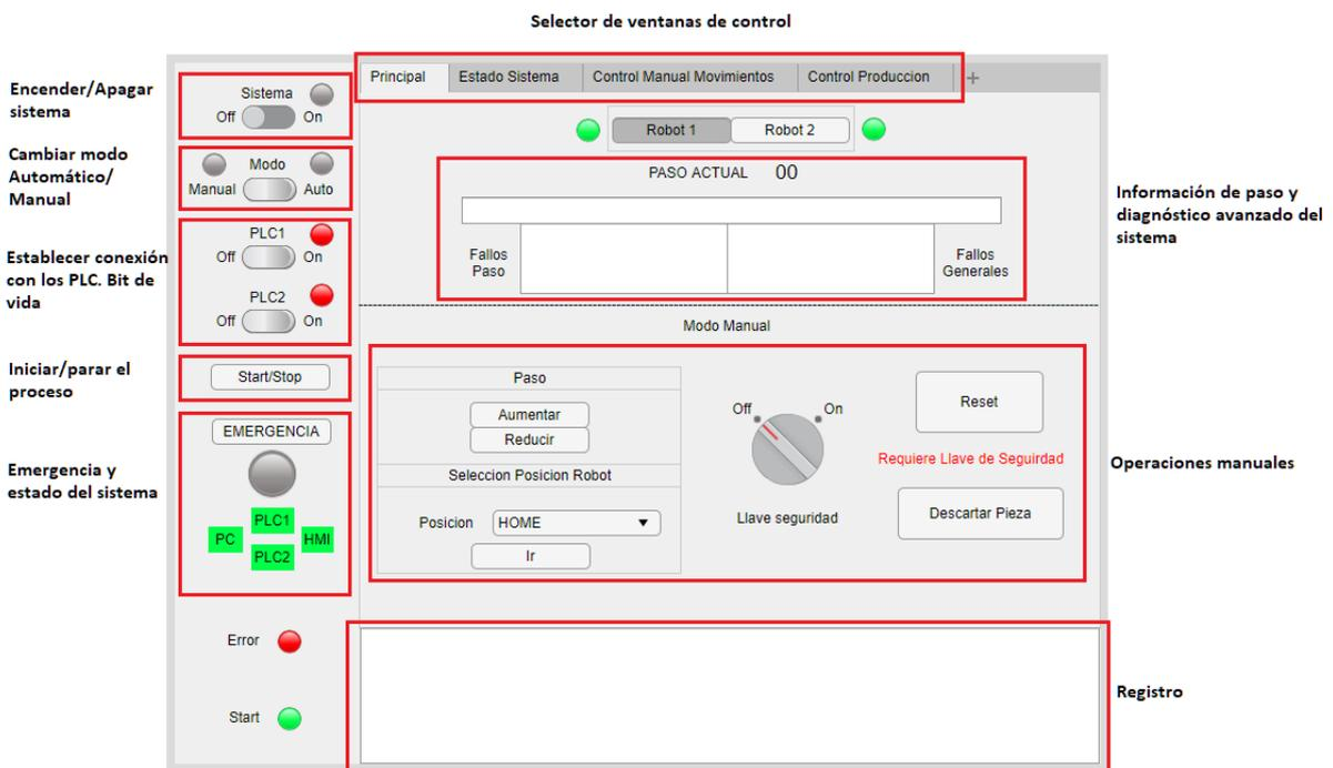
Ilustración 18 Pantalla principal SCADA. Fuente: Elaboración propia
