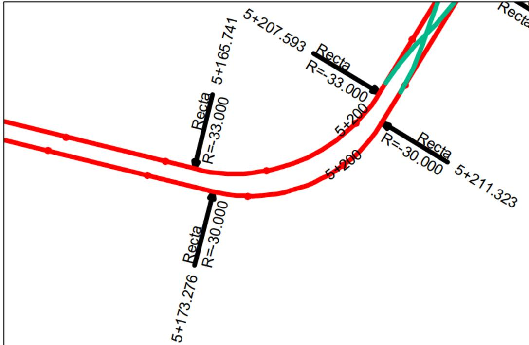
Figura 5.2: Radios de curvatura, 52 metros, en el trazado de la Línea 10. Fuente: Ferrocarrils de la Generalitat Valenciana
