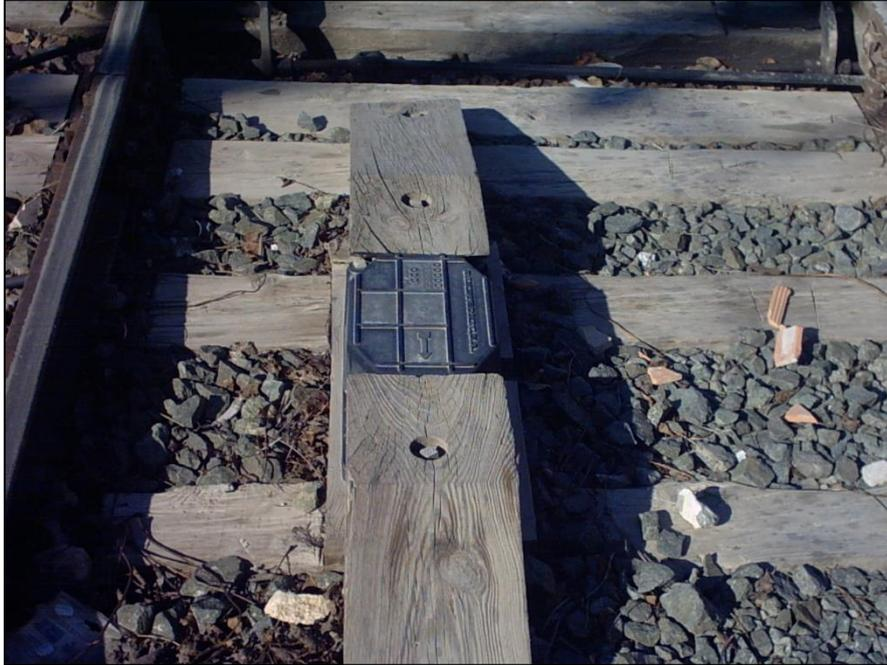
Figura 2.12: Baliza ASFA en la vía de Estación Novelda-Aspe, provincia de Alicante. (S. Martínez)
