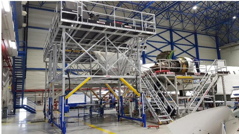
*ILUSTRACIÓN 6 Plataforma en posición de trabajo*
