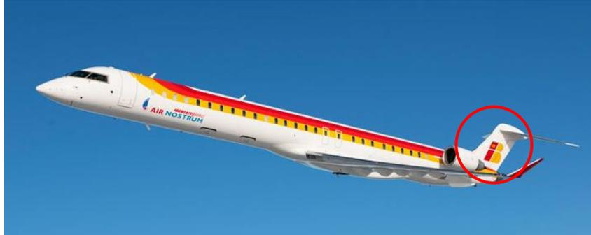
ILUSTRACIÓN 1 Estabilizador vertical de un avión Bombardier modelo CRJ 1000 de la flota de Air Nostrum (Fuente: <https://www.iberia.com/es/flota/air-nostrum/CRJ1000/>)
