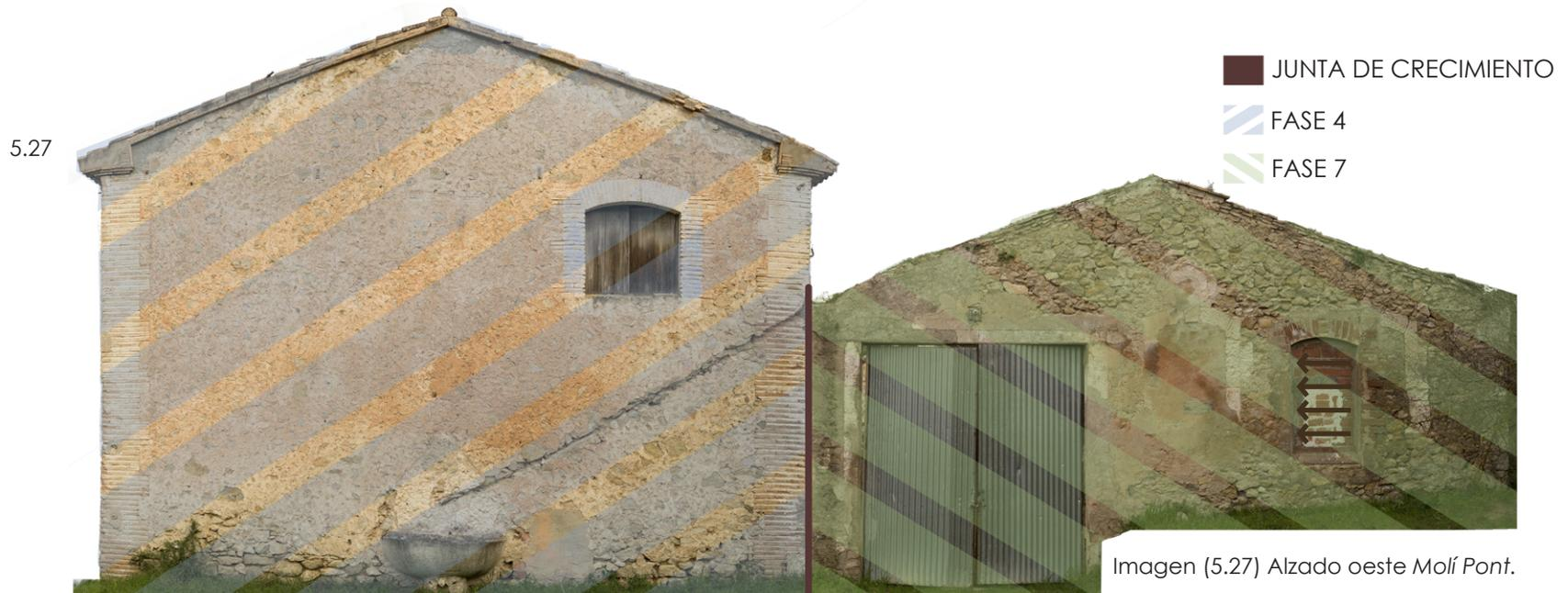
En el segundo plano del alzado oeste se encuentra la escalera de acceso a la planta baja del volumen principal y el acceso exterior al volumen de la caldera de vapor, en este alzado se aprecian dos huecos, el de la derecha se redujo su tamaño y se desplazó ligeramente hacia la izquierda, y el hueco de la izquierda, que es el de acceso, ha sufrido modificaciones de dimensión, pero su ubicación se ha mantenido sin desplazamientos.
