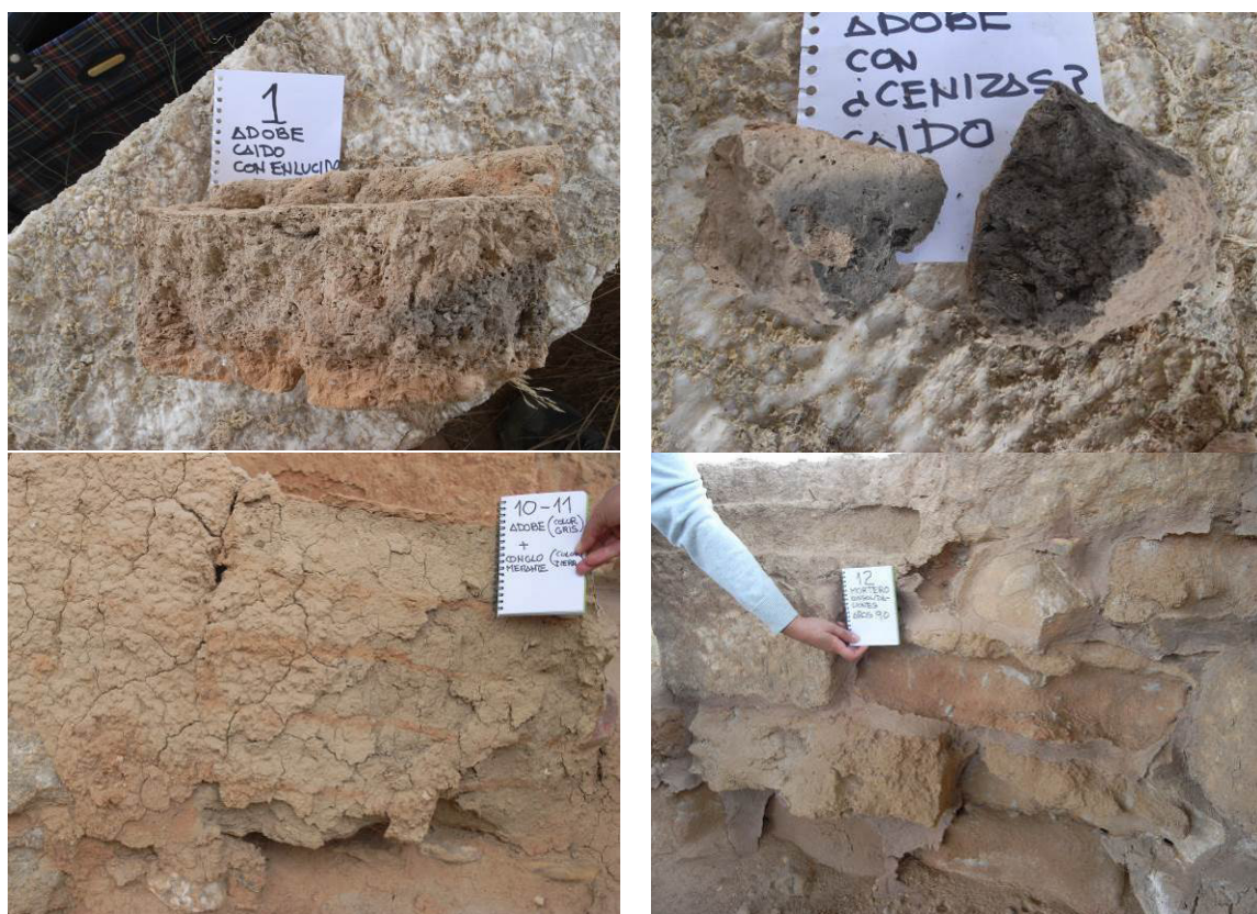
Fig. 78. Se lleva a cabo la localización y recogida de 12 muestras para poder realizar los análisis de laboratorio que nos permitan conocer, con exactitud, los componentes de sus fábricas y morteros, 2017.NOEMA RESTAURADORES SL
