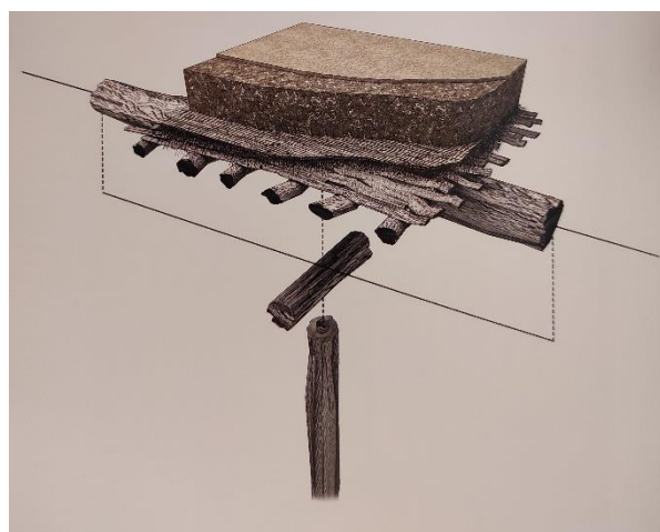
Imagen 61: Detalle constructivo: Pie derecho
