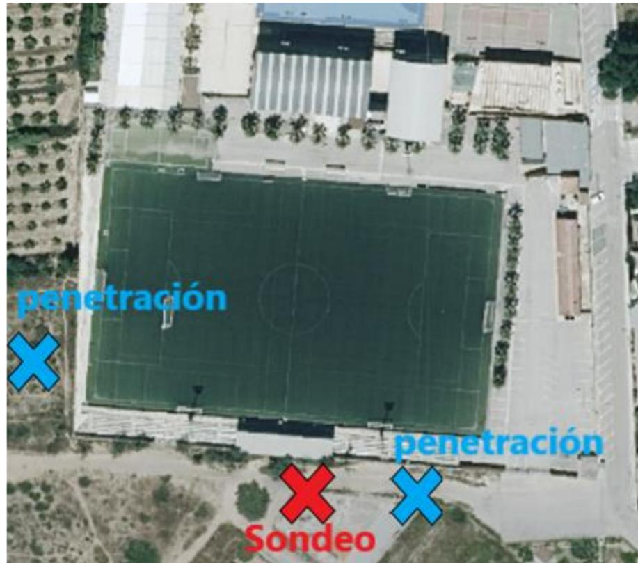
Ilustración 4. Ubicación de los sondeos y penetraciones dinámicas
