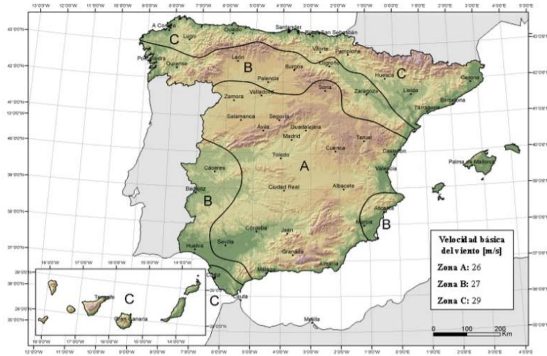
Ilustración 2. Velocidad básica del viento en España. (Fuente: CTE-DB-SE-AE).
