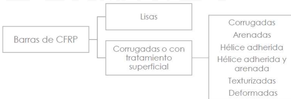
Figura 2.15 Esquema según geometría superficial de las barras de CFRP.
