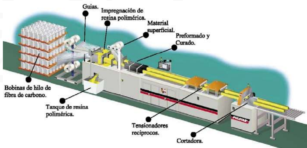
Figura 1.10 Proceso de pultrusión. Adaptado de Strongwell
