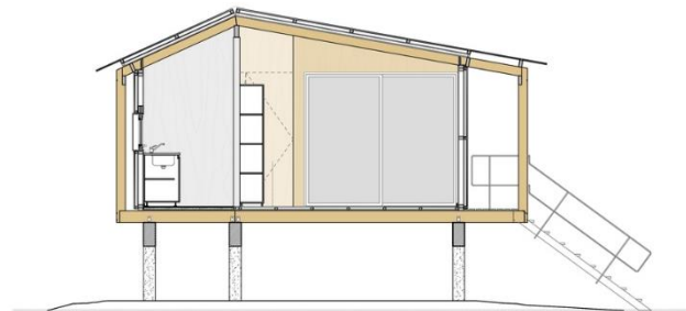
Fig. 133 Casa Dique Luján – Sección transversal
