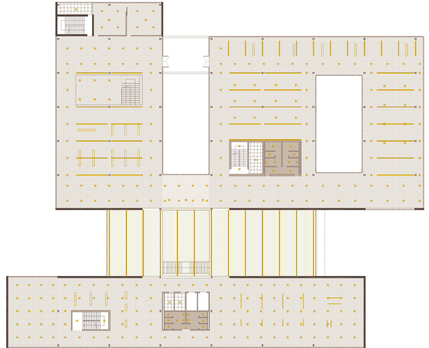
Planta primera luminarias escala 1:400
