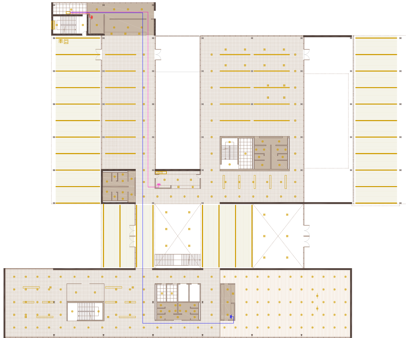
Planta baja luminarias escala 1:400
