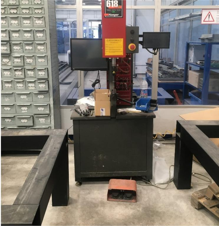
*Ilustración 20: Máquina de insertado*
