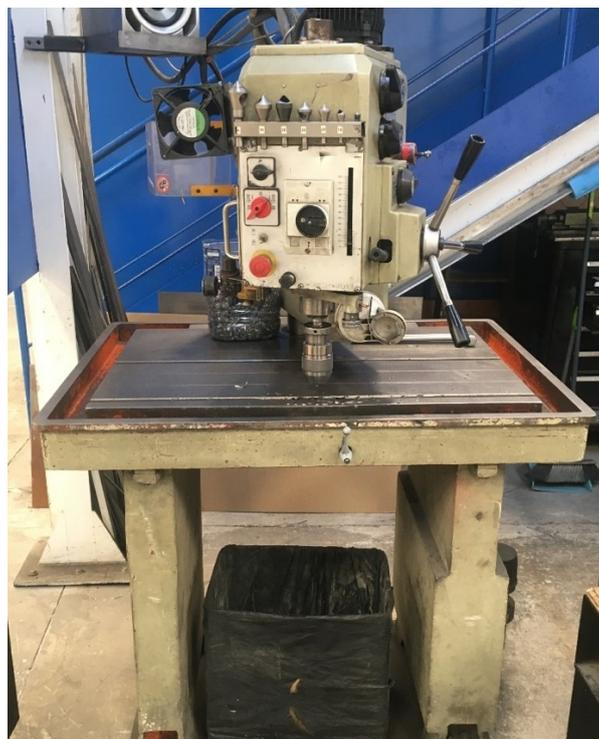
*Ilustración 12: Taladro de mecanizado.*
