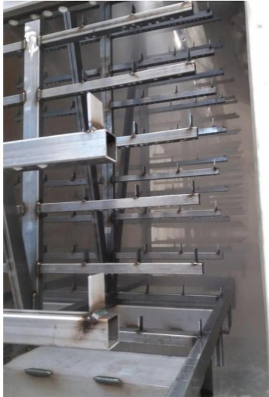
*Ilustración 21: Pieza entrando a la cabina de pintura en polvo.*
