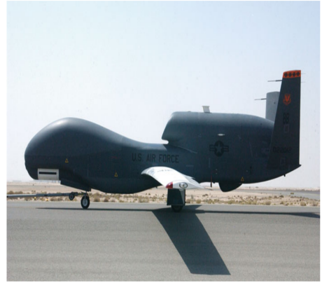
(b) El RQ-4 Global Hawk es un UAV de gran altitud y resistencia. Fue el primer UAV en hacer una travesía transpácífica. Fuente: Fuerza Aérea de los Estados Unidos, Sargento Mayor Jason Tudor.
