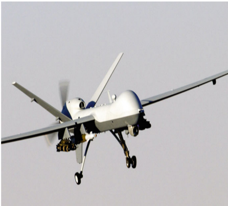
(c) MQ-9 Reaper es una versión actualizada del UAV Predator. Se utiliza principalmente como un UAV persistente cazador-asesino. Fuente: Fotografía de US Fuerza Aérea, Sargento de Estado Mayor Brian Ferguson.
