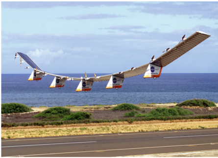
(a) UAV Helios desarrollado por la NASA y AeroVironment. Durante su segundo vuelo a gran altitud alcanzó los 96,863 pies. Fuente: Fotografía: NASA.
