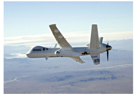
(d) El Ikhana es un UAV Predator B, adquirido por la NASA y adaptado para misiones científicas. Fuente: Fotografía de la NASA.
