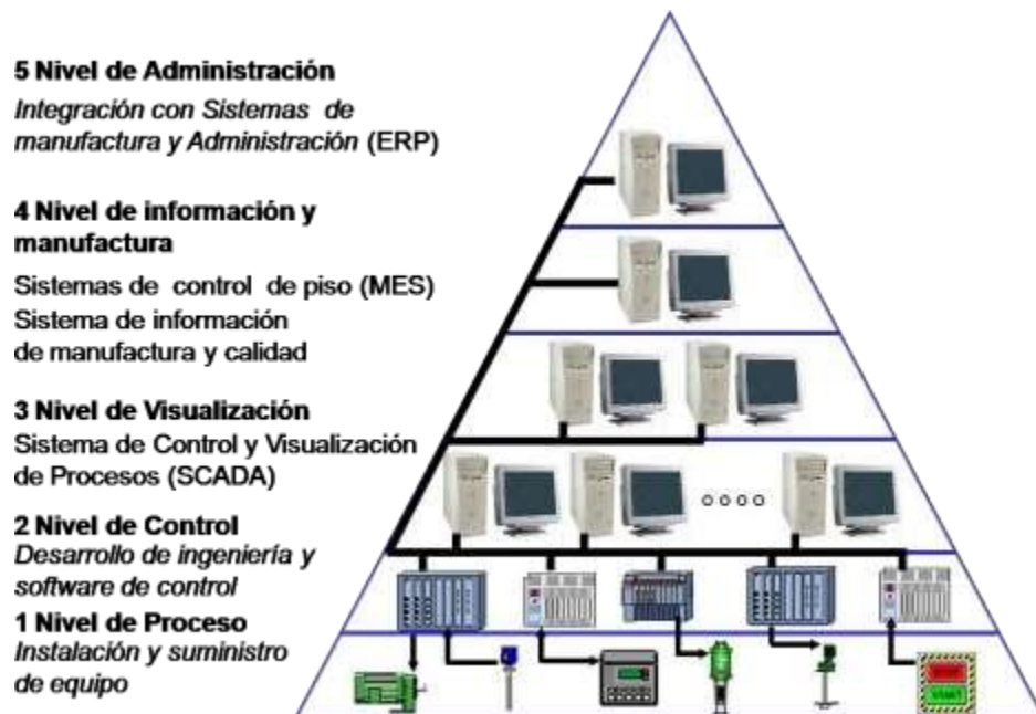
Ilustración 14. Pirámide de automatización.
