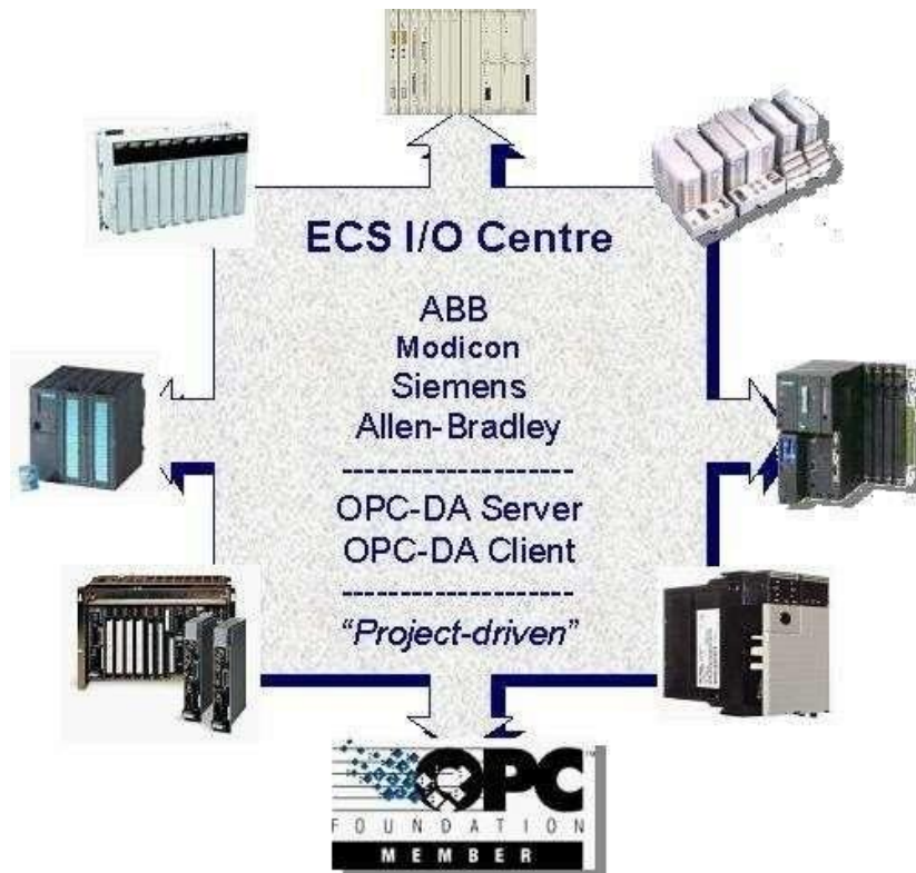
Ilustración 37. Drivers de comunicación con ECS I/O Centre.
