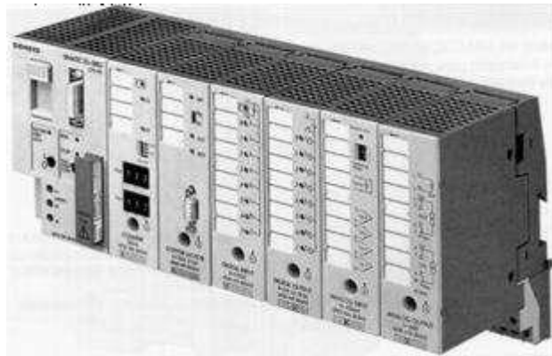
Ilustración 21. Autómata S5 de Siemens.
