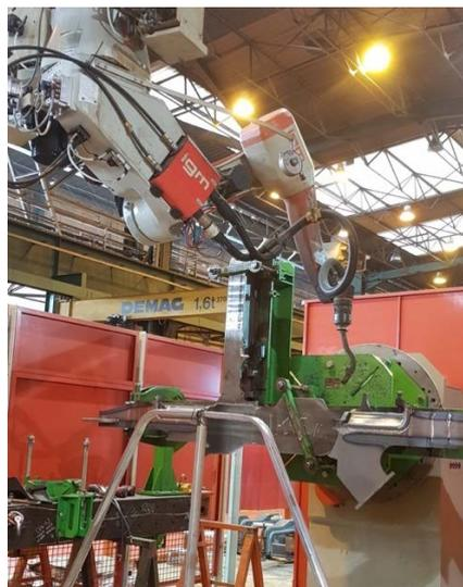
Figura 33: Estación robotizada de soldadura de largueros [Fuente: Stadler Rail S.A.U.]
