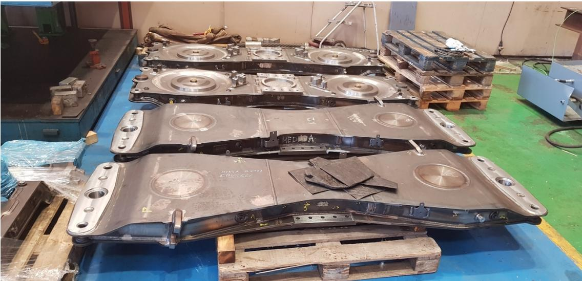
Figura 24: Ejemplos de Travesas bailadoras de un bogie. [Fuente: Stadler Rail S.A.U.]
