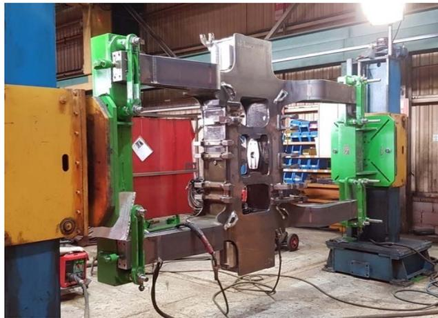
Figura 32: Bastidor motor con soportes en virador de doble columna [Fuente: Stadler Rail S.A.U.]
