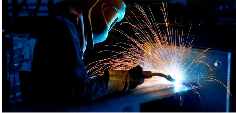
Figura 48. Ejemplo de soldadura manual con hilo. [Fuente: [31]]
