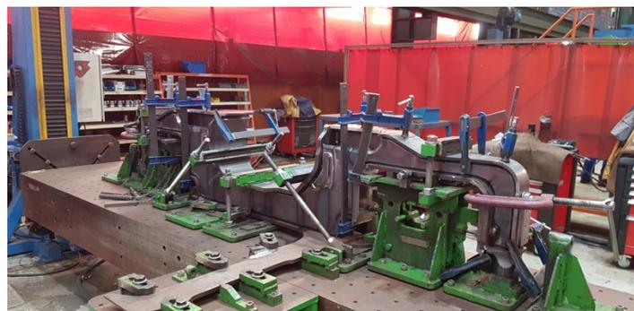
Figura 31: Montaje de larguero sobre útil y mármol [Fuente: Stadler Rail S.A.U.]
