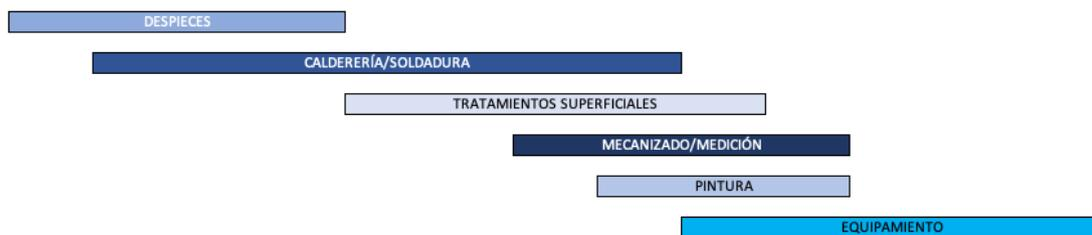
Figura 27: Proceso de fabricación general del Taller de Bogies [Fuente: Elaboración propia]
