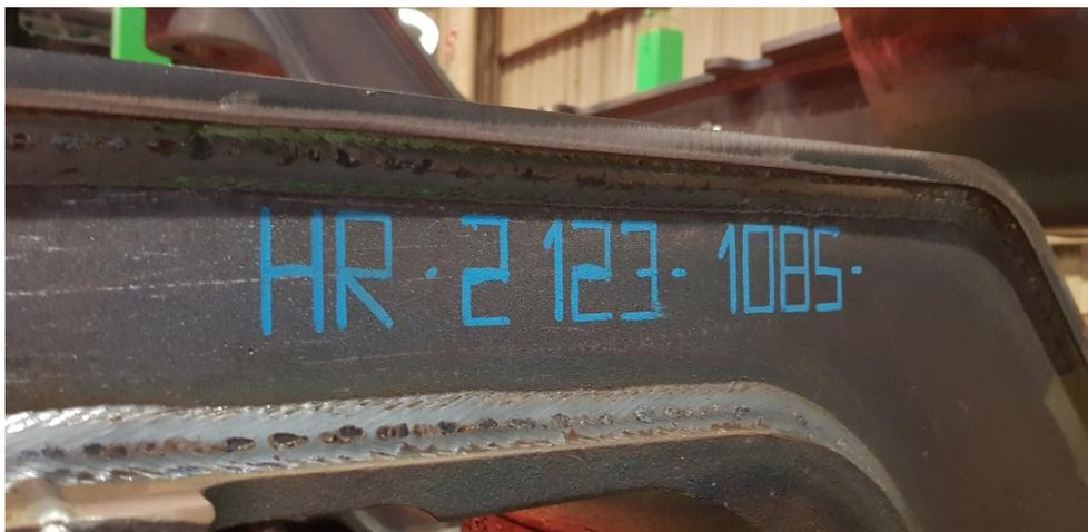
Figura 69. Identificación de conjunto en el Taller de Bogies [Fuente: Stadler Rail S.A.U.]
