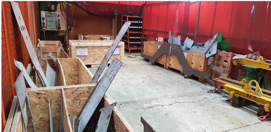
Figura 29: Plantillas de oxicortes [Fuente: Stadler Rail S.A.U.]
