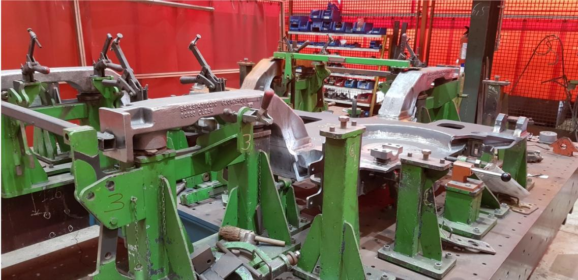
Figura 59. Ejemplo de útil de calderería [Fuente: Stadler Rail S.A.U.]
