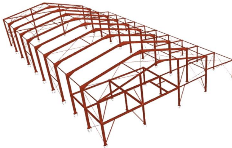
Ilustración I.1. Estructura metálica del edificio industrial
