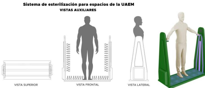
Fig. 2 Simulación 2D y 3D de la desinsectación por medio del sistema con luces UV-C.
