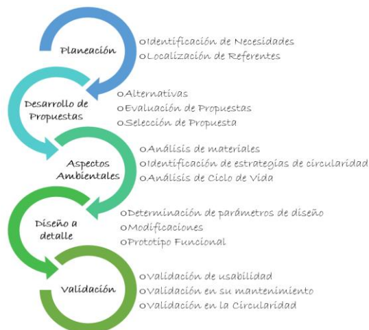
Fig. 4 Metodología para el análisis de ciclo de vida de materiales desechables Fuente: imagen de elaboración propia
