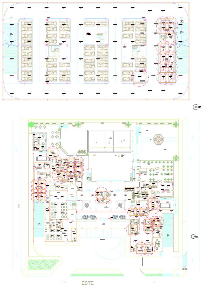
Figura 85. Ejemplos disposición final y coberturas en planos Sótano 2 y Planta Baja. Detectores Térmicos.
