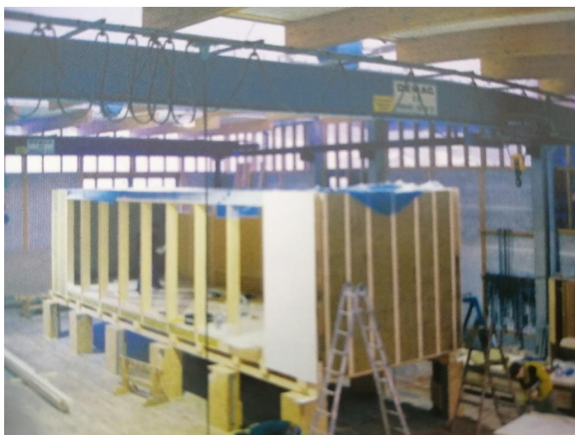
Figura 51. Vivienda Fred en proceso de fabricación. Se termina en fábrica para ser trasladada a obra. (Ignacio Martínez, 2001)
