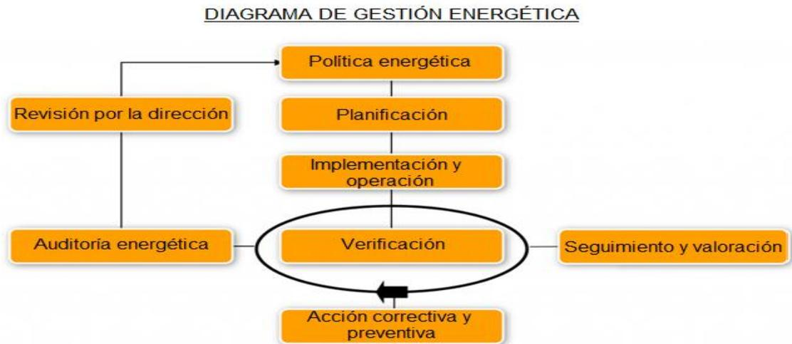
Fig. (7) Diagrama de gestión energética según norma UNE 16001:2010
