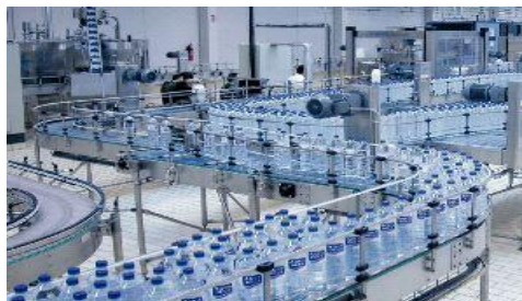
Ilustración 16: Transporte de los envases ya etiquetados
