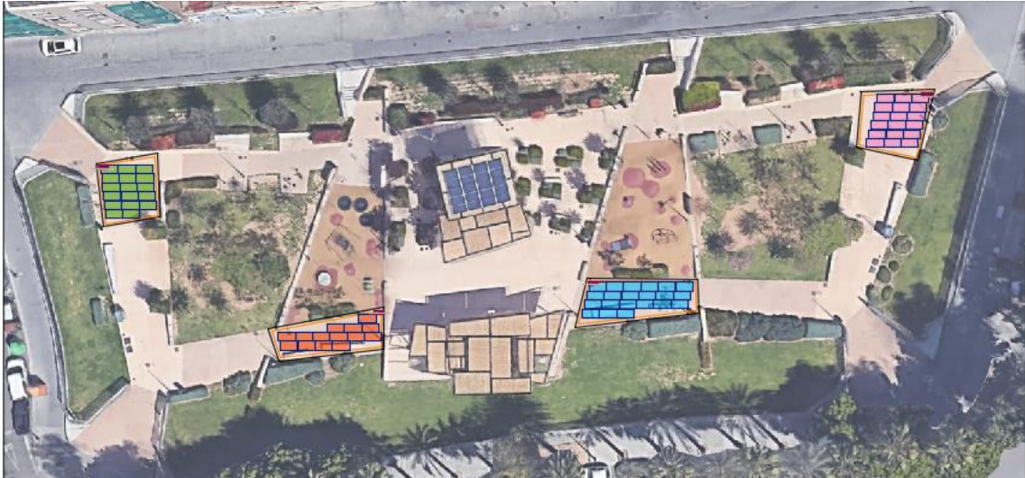
Ilustración 21: Subdivisión de las pérgolas por strings.
