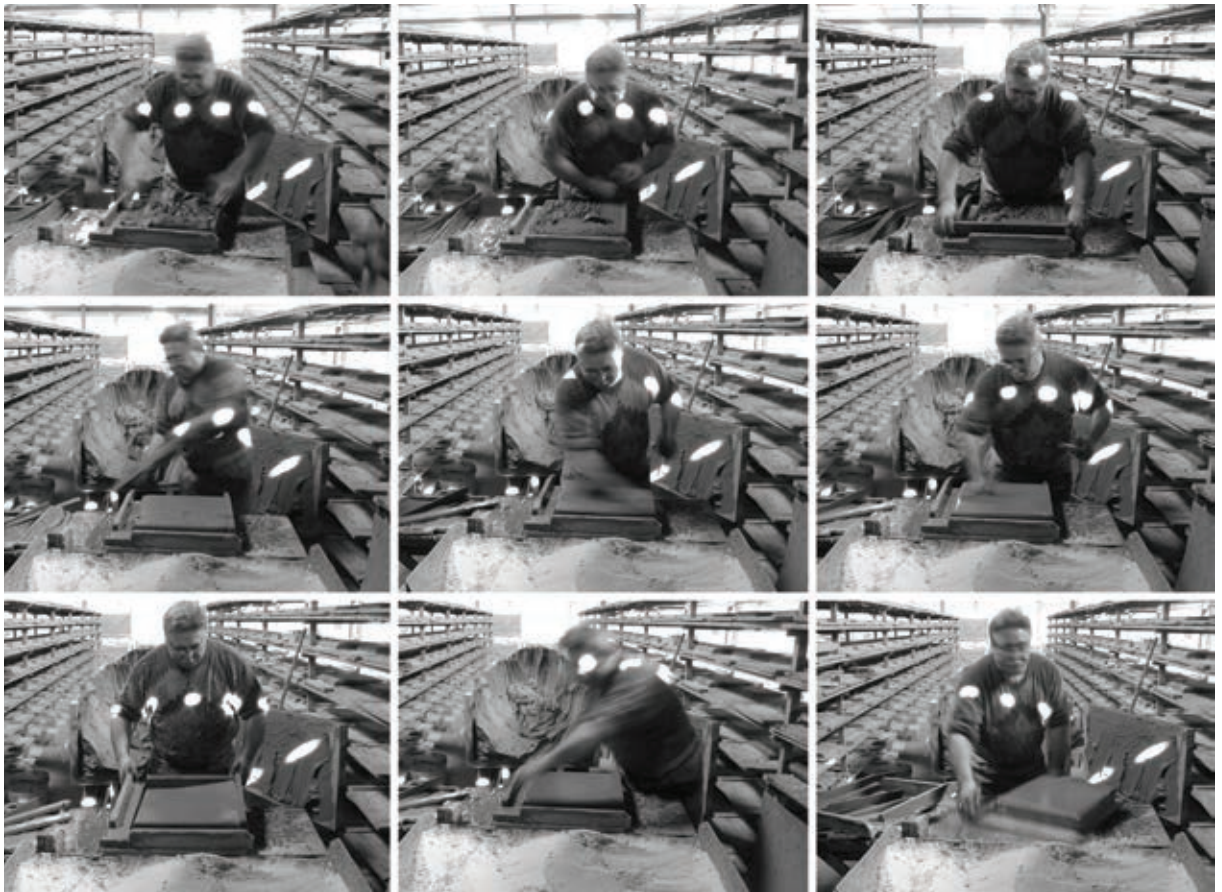
Fig. 06 Artesano elaborando terracota manual en la fábrica de cerámica Decorativa de Oliva . Fotografía de De Miguel, E., 2009.
