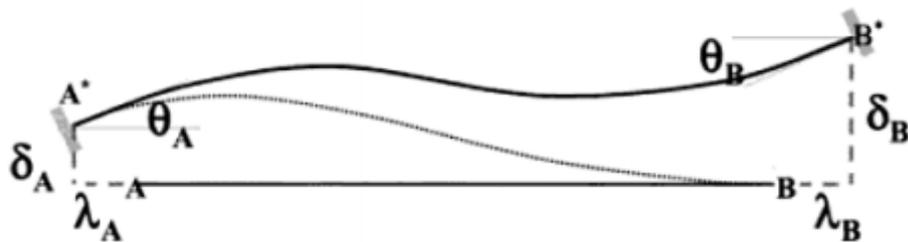
Ilustración 1: Comportamiento elástico de una barra
