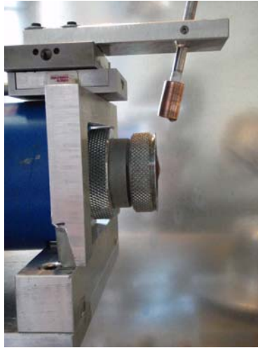
Figura 4.20. Módulo de eyección de la suspensión en el chorro de plasma
