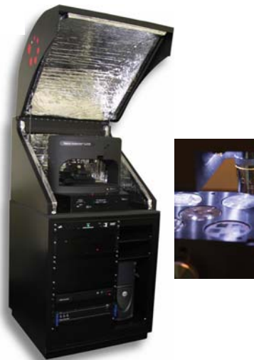
Figura 4.21. Nanoindentador para determinación de propiedades mecánicas
