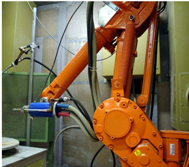
Figura 4.19. Equipo de proyección por plasma atmosférico
