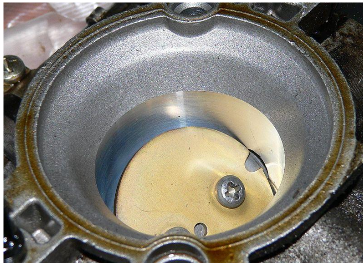
Fig. 4.1.5e Válvula de mariposa del acelerador de un motor Otto
