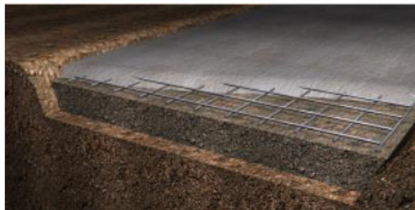
Figura 23: Disposición de las diferentes capas de la solera
