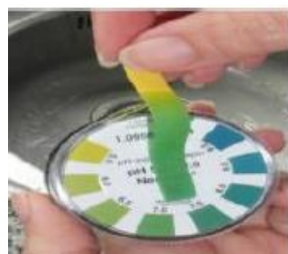
Figura 11. Tiras de papel de tornasol para medida de pH (izquierda) y test colorímetro para concentración de amonio, nitratos y nitritos (MERCK) (derecha).
