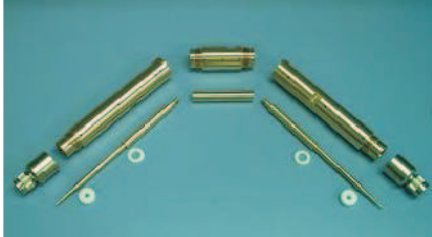
Figura 4.6: Transformador de cuarto de onda en guía coaxial, gap d = 1 \text{ mm} .
