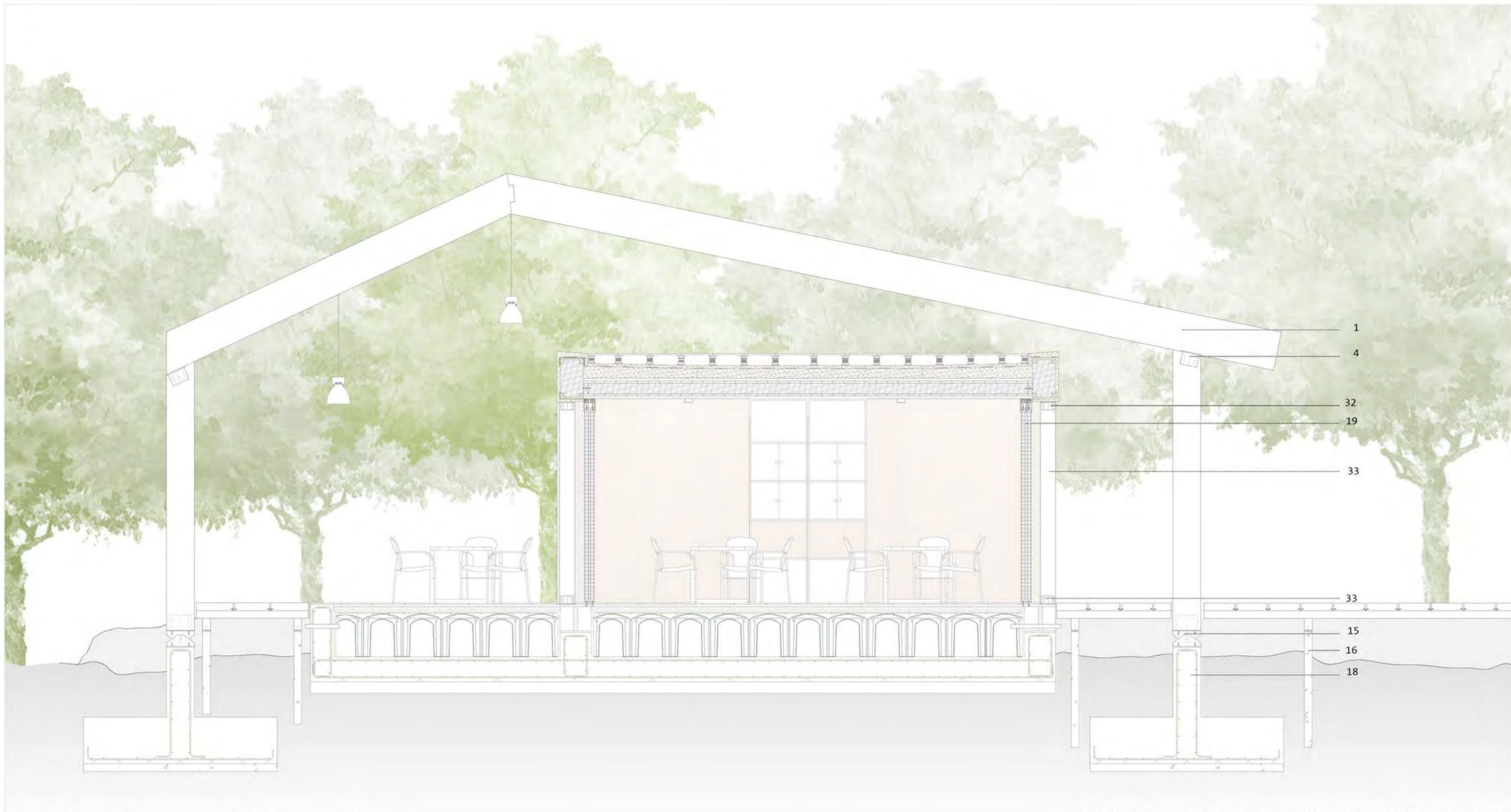
32. Anclaje de los pilares de madera. Anclaje metálico oculto.
