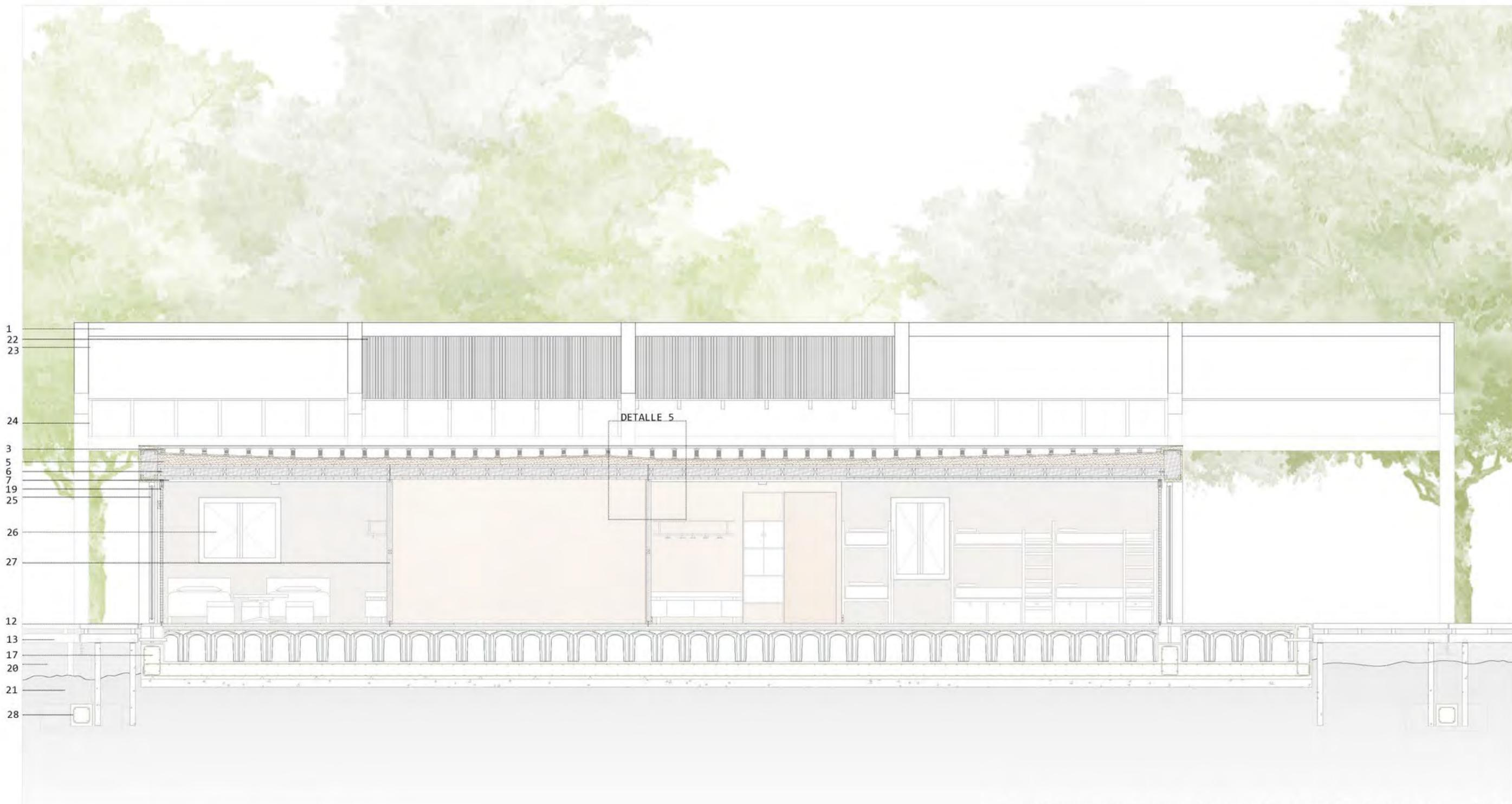
Sección constructiva 2. Sección longitudinal por un núcleo de habitaciones. E: 1/70
