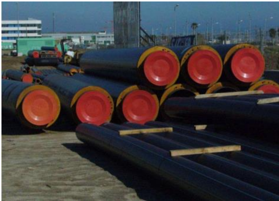
Figura 4: Tuberías pre-aisladas para una red de distrito
