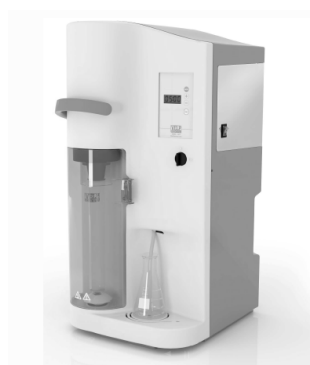
Imagen 2. Unidad de destilación
