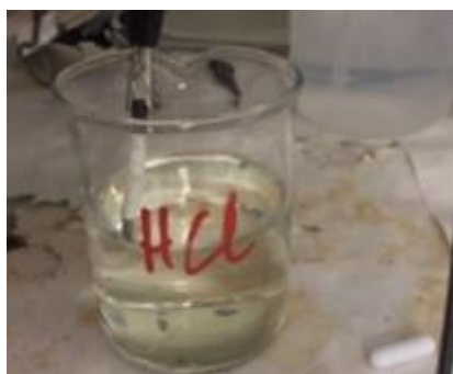
Figura 28. Decapado en disolución de ácido clorhídrico
