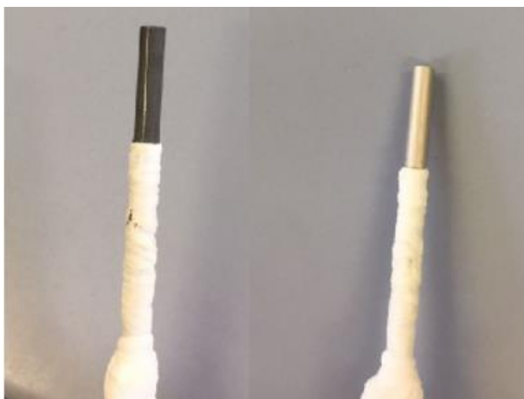
Figura 31. Comparación del aspecto de la muestra antes (izquierda) y después (derecha) de la electrodeposición
