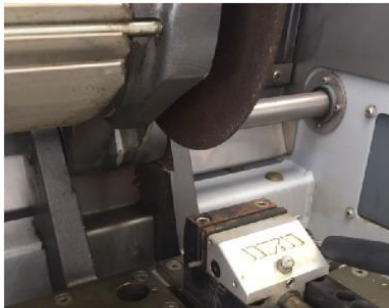
Figura 25. Material base en la cortadora
