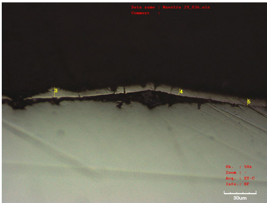
Figura 37. Microscopía óptica de la muestra embutida: tres últimas medidas
