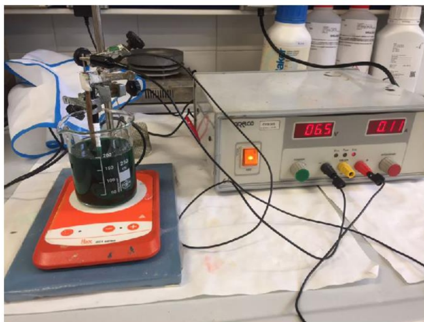
Figura 30. Montaje durante la reacción de electrodeposición
