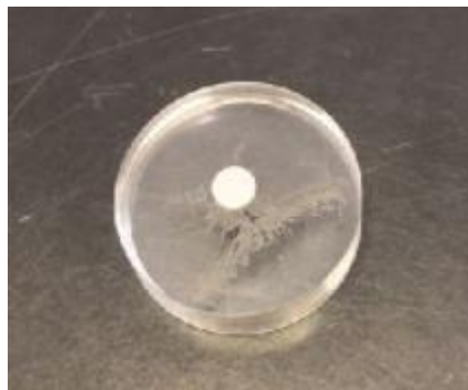
Figura 32. Preparación metalográfica de la primera deposición
