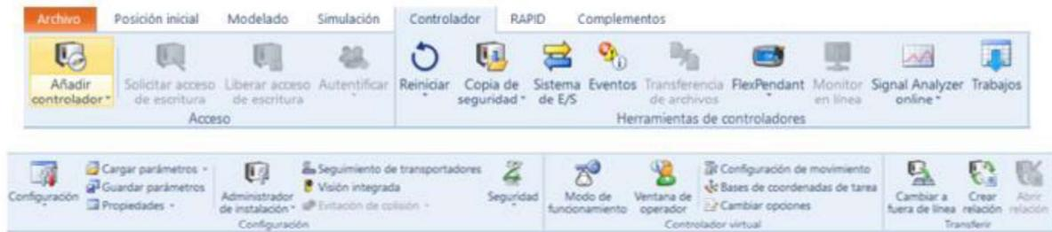
Ilustración 19. Pestaña "Controlador" en dos bloques. Fuente: programa RobotStudio 2020
