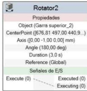
Ilustración 43. Bloque de componente inteligente "Rotator2". Fuente: programa RobotStudio 2020
