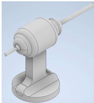
*Ilustración 57. Máquina taladradora con anclaje para robot. Fuente: elaboración propia*
