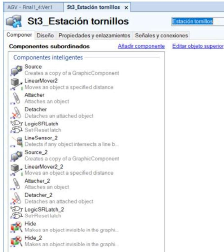
Ilustración 29. Listado de bloques de componentes añadidos. Fuente: programa RobotStudio 2020
