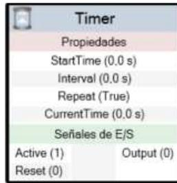
Ilustración 33. Bloque de componente inteligente "Timer". Fuente: programa RobotStudio 2020
