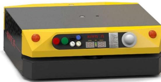
Ilustración 1. AGV tipo mouse modelo K05 Twister. Fuente: página web de la compañía Kivnon
