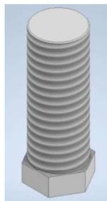
Ilustración 50. Tornillo de longitud 13mm y radio 5. Fuente: elaboración propia
