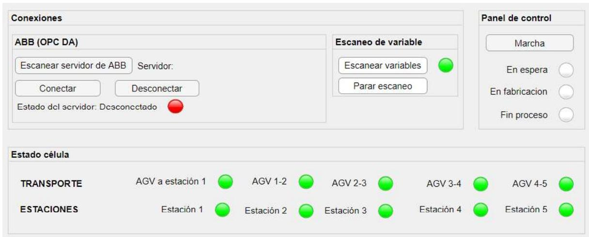
Ilustración 100. SCADA de la línea de fabricación de drones. Fuente: elaboración propia.
