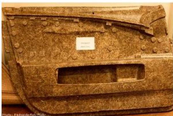
Figura 4. Puerta de automóvil construida con fibras de cáñamo (Fuente: Bioguía)
