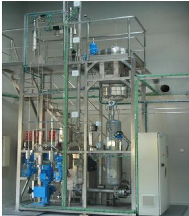
Figura 19. Planta completa de extracción de fluidos supercríticos. (Fuente: Interempresas)
