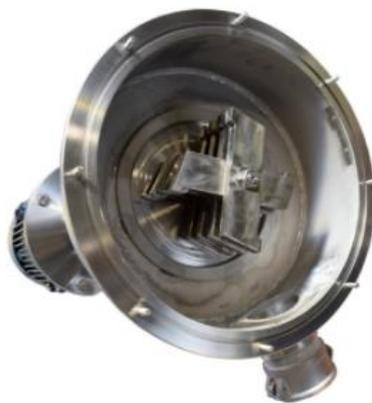
Figura 15. Molino de martillos marca Pimecsa. (Fuente: Pimecsa)
