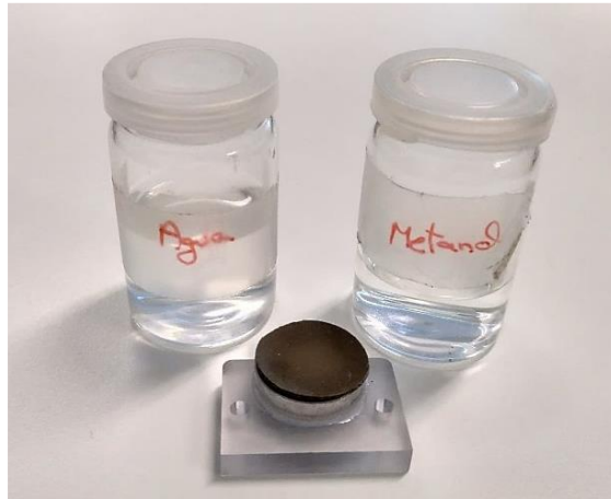
Figura 21. Calibradores usados para la calibración de cuatro estándares: agua (izquierda), metanol (derecha) cortocircuito (abajo).
