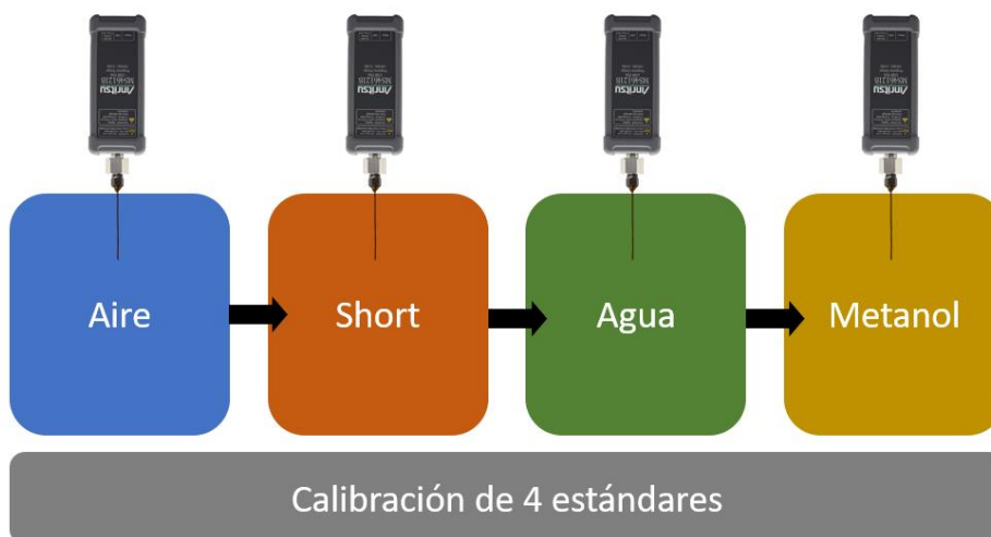
Figura 32. Esquema del procedimiento en la calibración de 4 estándares.
