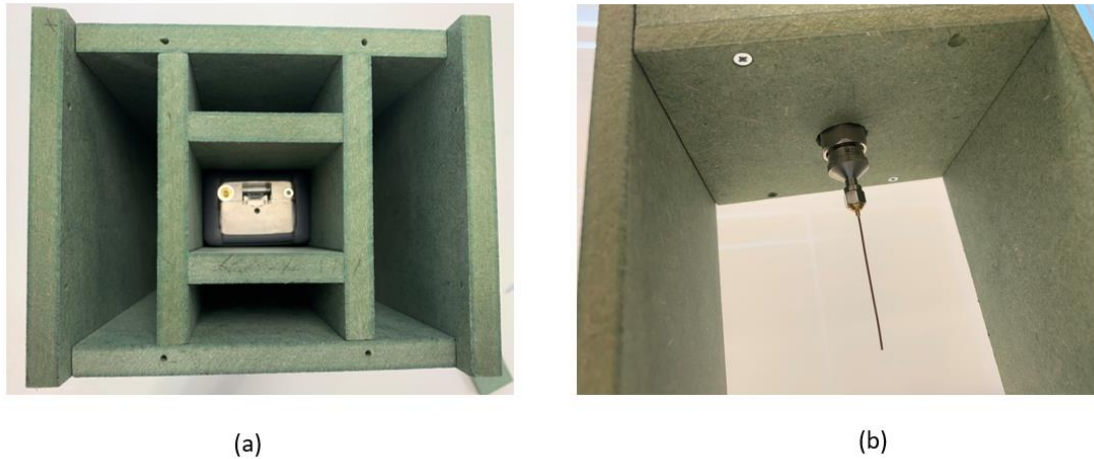
Figura 37. Prototipo. (a) Estructura de sujeción interna; (b) Salida de la sonda coaxial.
