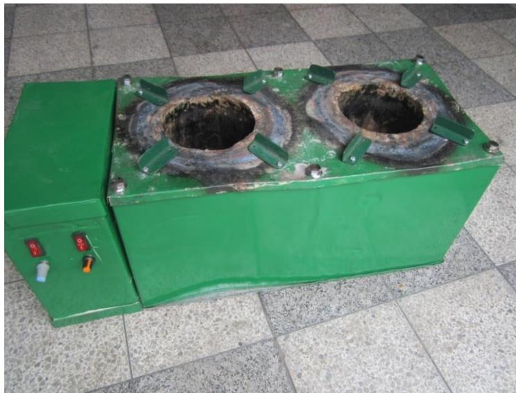
Fig.5.17. Estufa de gasificación de doble reactores ICS-G2.
