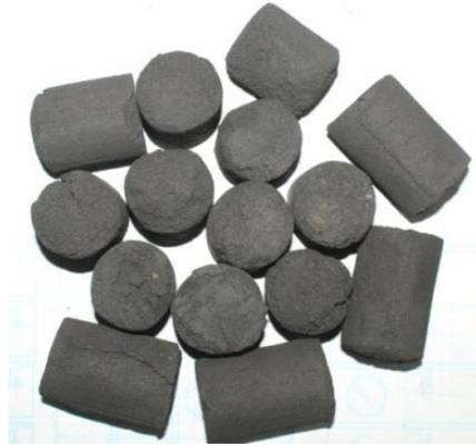
**Fig. 3. 2. Briquetas BSW3 densificados.**
