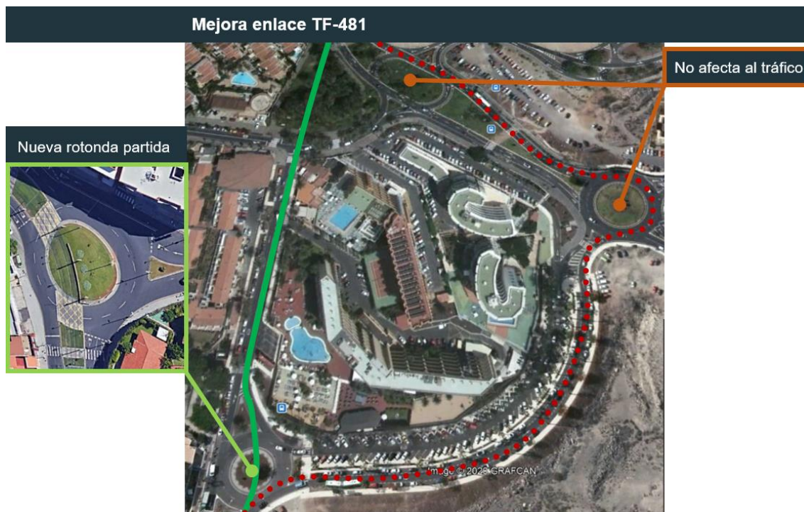
Ilustración 56: El desvío de las líneas del BRT a través de la Calle Bolivia (en verde) evita la circulación de gran número de guaguas a través de las rotondas de acceso a Costa Adeje, aliviando así el tráfico que se da hoy en día (en rojo, el recorrido actual). Elaboración propia
