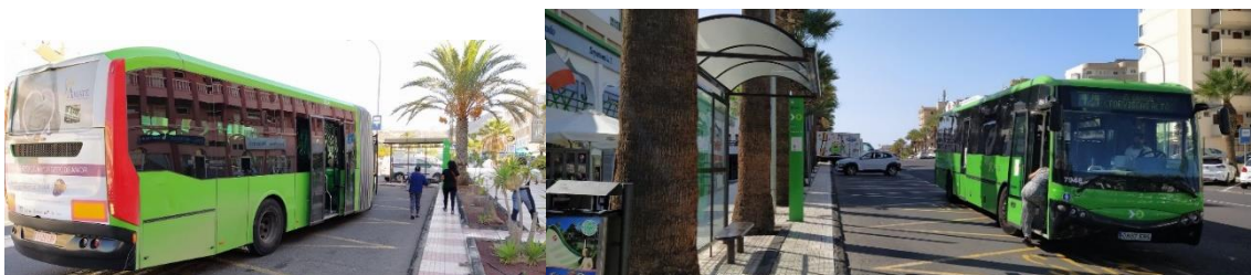
Ilustración 25: El excesivo ancho de la zona de detención dificulta el acercamiento a la acera y la necesidad de caminar por la calzada. El uso de elevadores o rampas se hace imposible. Foto: Joel Leiva
