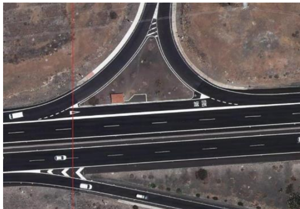
Ilustración 31: Parada en el enlace de Parque La Reina (7137) Cuenta con espacio para el despliegue de rampas elevadoras para vehículos de piso alto, pero no cuenta con itinerarios de acceso a la propia parada. Imagen: IDECanarias - Grafcan
