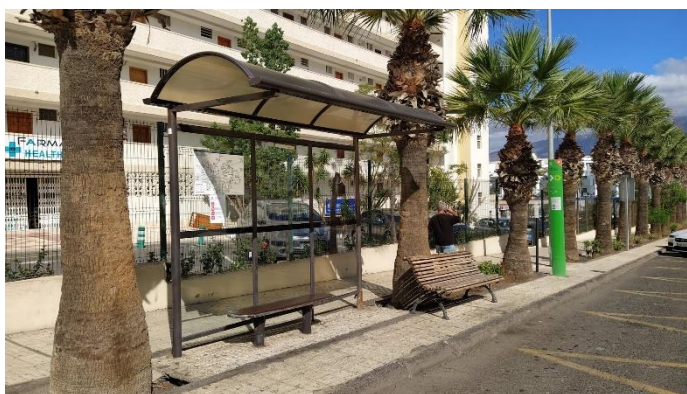
Ilustración 23: Marquesina tipo de Arona, se aprecia la estrechez de la acera para circular con sillas de rueda o carritos de bebé por la presencia de un jardín. Foto: Joel Leiva
