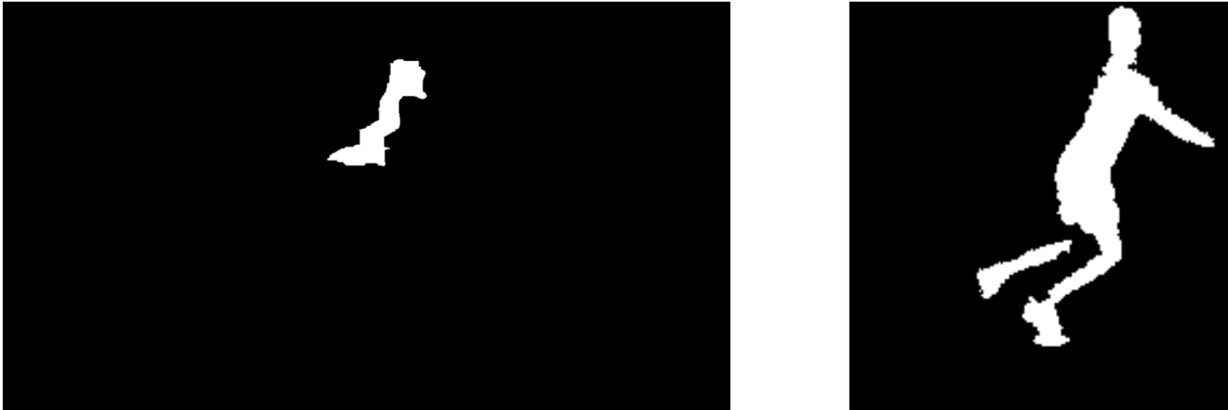
Figura 4.23. Izquierda: Frame tras filtrar los grupos de pixeles menores de 8000. Derecha: Frame tras recortar el bounding box sobre la imagen original y aplicar el algoritmo K-Means
