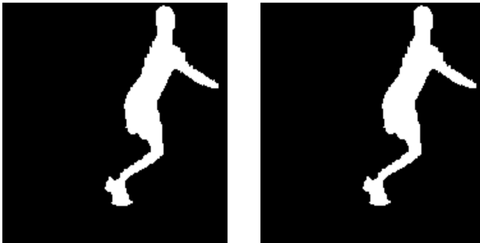
Figura 4.25. Izquierda:Frame tras aplicar filtro areas de 1800 Pixels. Derecha: Frame tras filtrar por solidez
