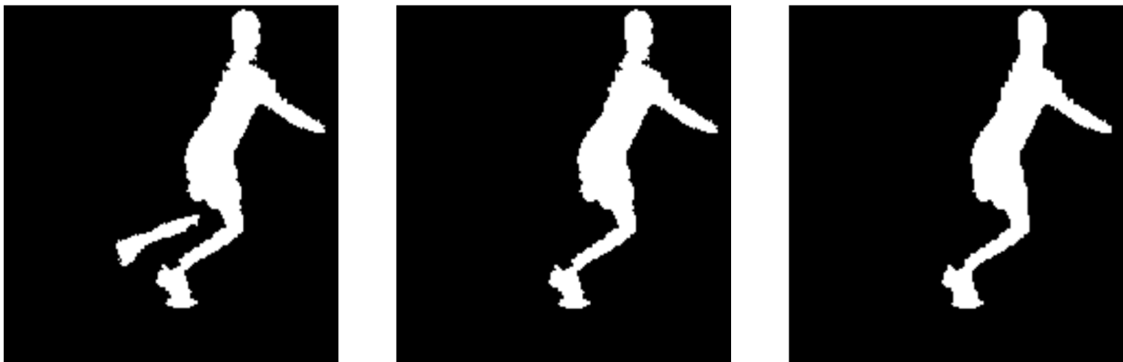
Figura 4.24. Izquierda: Frame Tras aplicar algoritmo K-Means. Centro: Frame tras aplicar filtro areas de 1800 Pixels. Derecha: Frame tras aplicar el operador close
