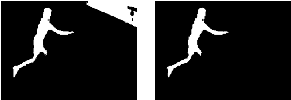
Figura 4.26. Izquierda: Frame 2 tras aplicar filtro areas de 1800 Pixels. Derecha: Frame 2 tras filtrar por solidez
